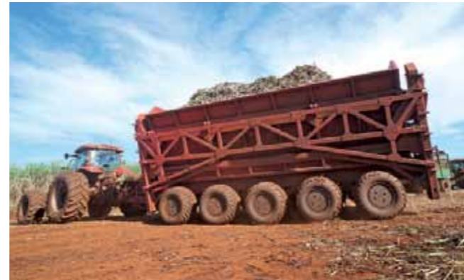
In Brasilien entstanden vor allem Aufnahmen von der Zuckerrohrernte, wie hier mit einem TMA-Überlader.
